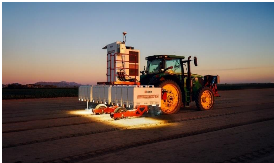
Рисунок 1 - Робот Carbon Robotics LaserWeeder в процессе лазерного уничтожения сорняков
